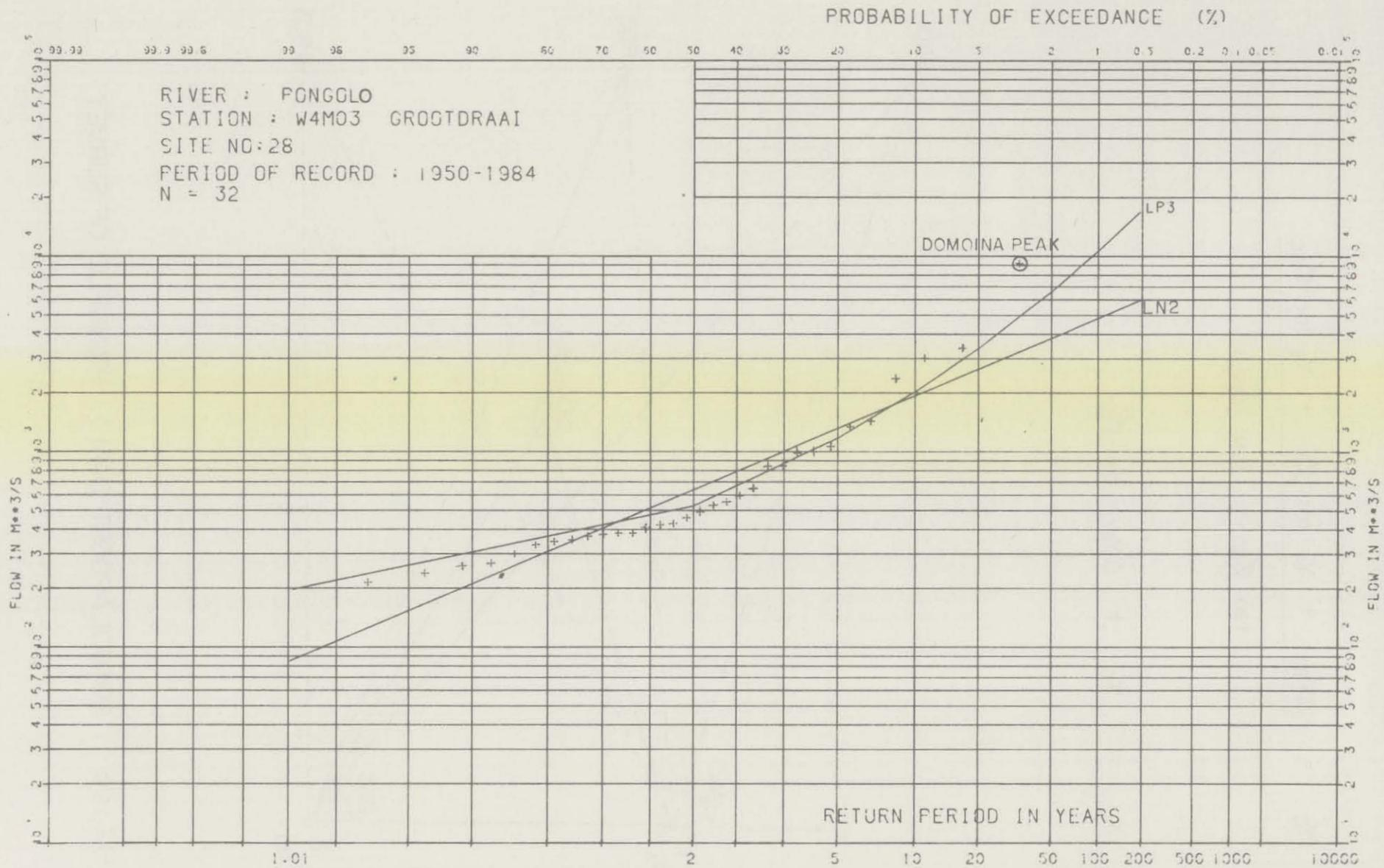
FIG.5.1 FLOOD PEAK FREQUENCY DISTRIBUTIONS AT SITE 28
