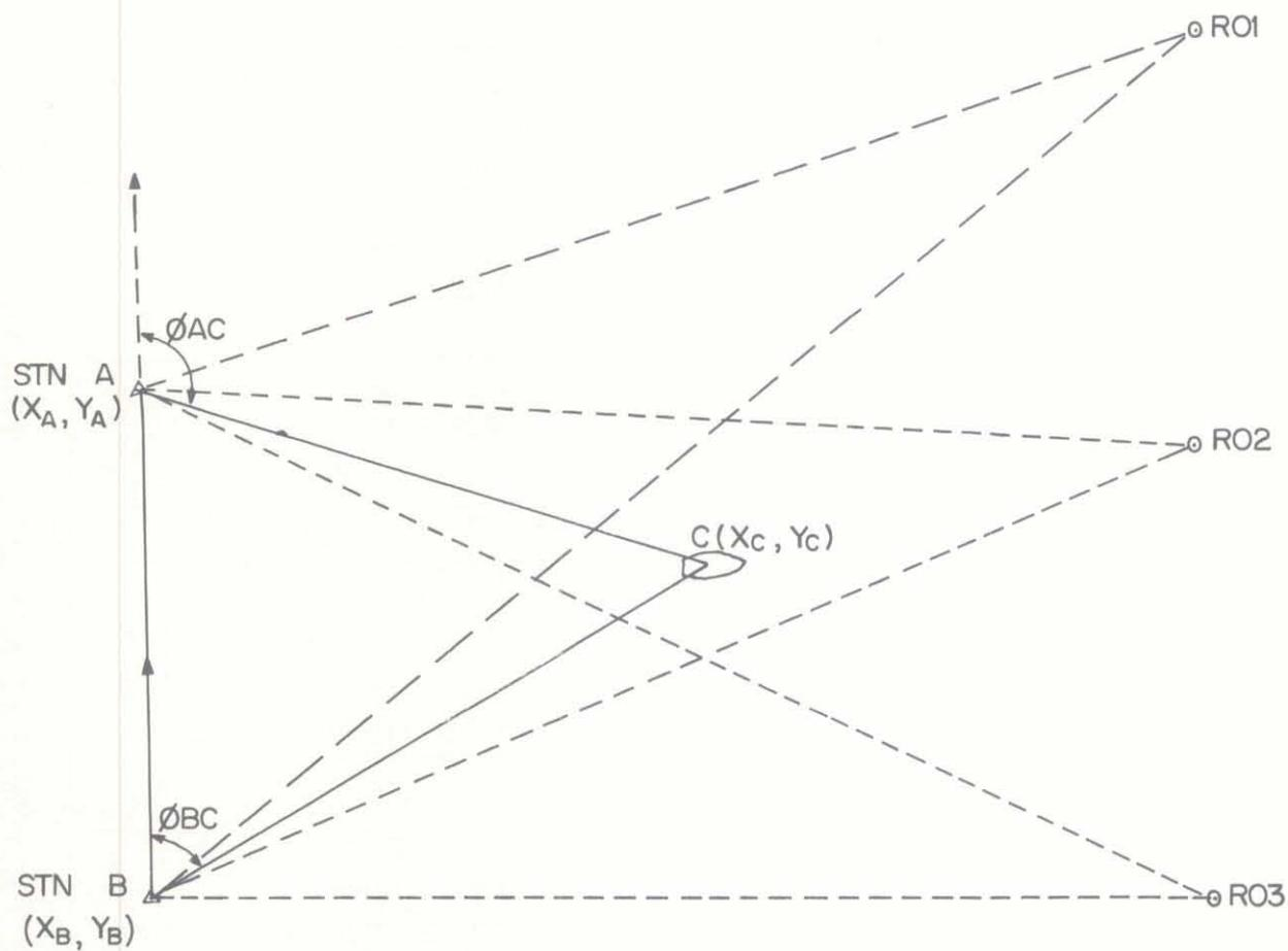
FIG. 4.5 PONGOLAPOORT DAM : PRINCIPLE OF SURVEY
