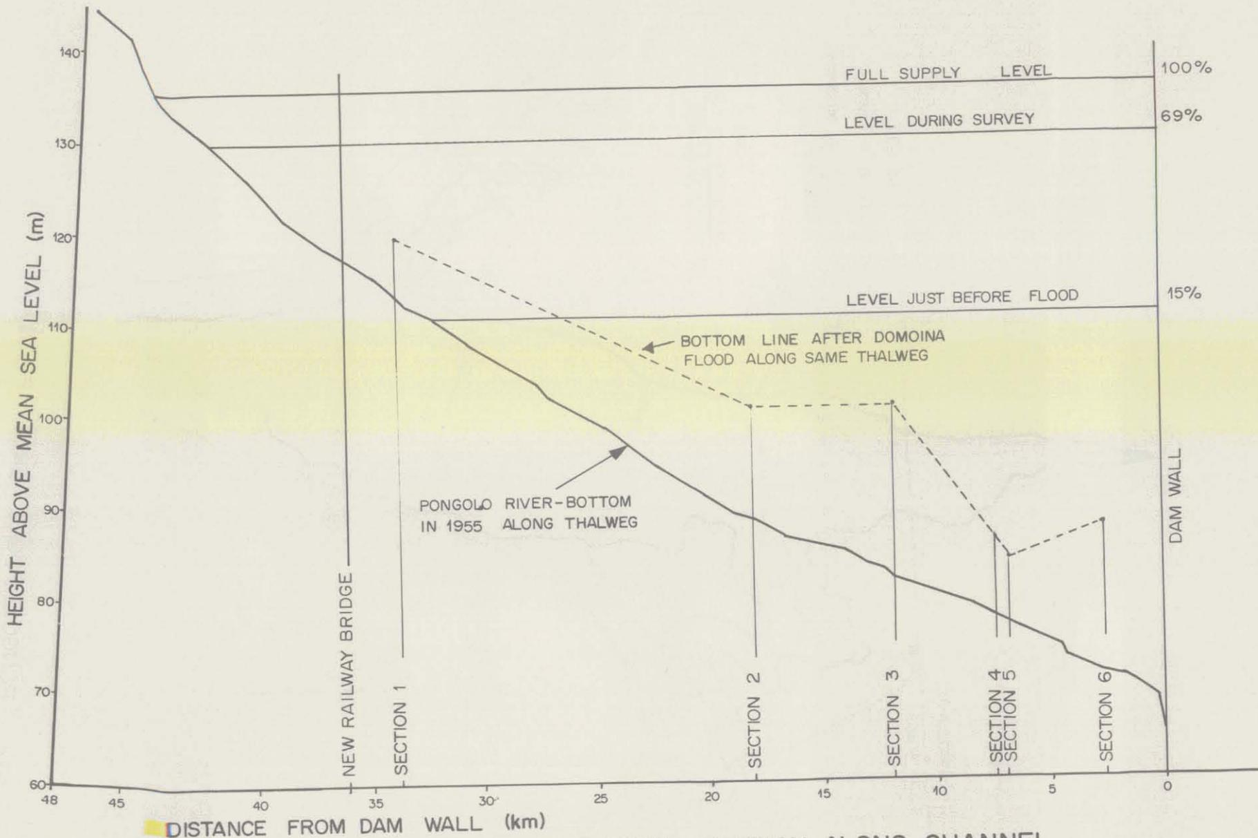
FIG. 7.4 **b** PONGOLAPOORT DAM: LONGITUDINAL SECTION ALONG CHANNEL
